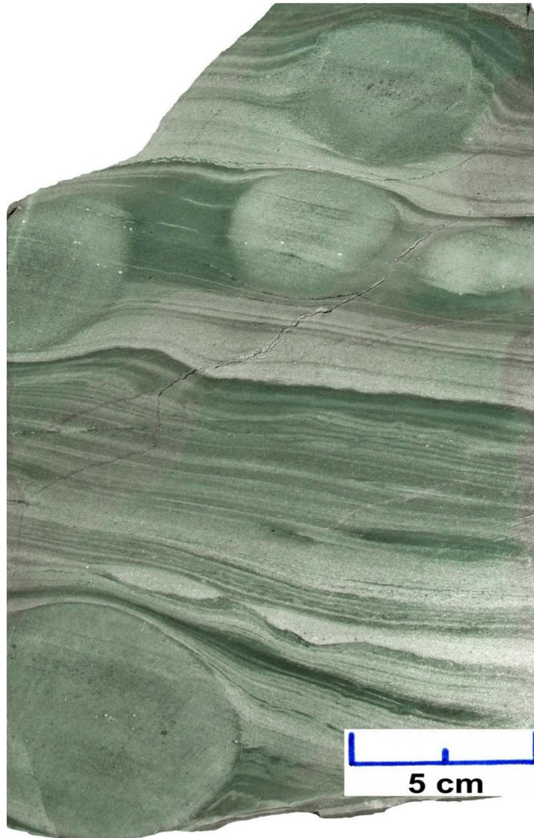
**Abb. 20.** Laminiertes bis feingeschichtetes Aschentuff mit Calcitknollen aus dem Bereich des Klostergrundes (*Fundort*: oberhalb des großen Teiches von Volkmarkeller).
