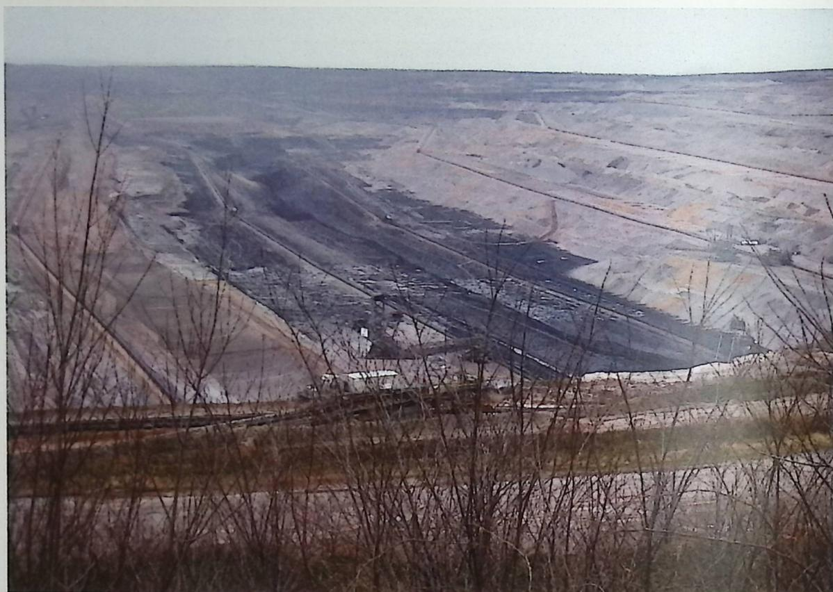
**Abb. 3:** Tagebau Hambach: Blick von Nord nach Süd - links Abbauseite, mitte Braunkohlenflöz, rechts Kippenseite. (Breite des Bildausschnittes ca. 2 km)
